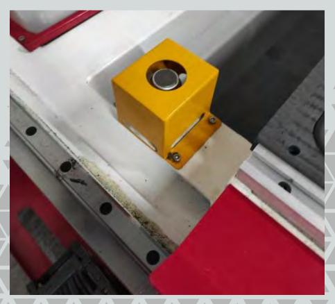
Les machines proposées avec le LNC 2200 sont équipées de palpeurs d'outils automatiques qui sont actionnés via une séquence commandée sur le pupitre
