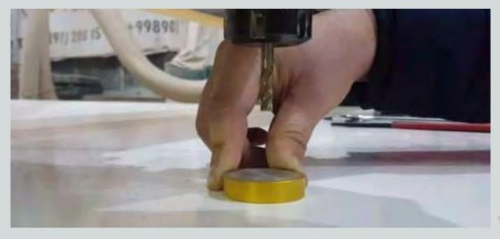
Les machines proposées avec la télécommande série DSP A 11 et A 18 sont équipées de palpeurs à poser sur la matière
